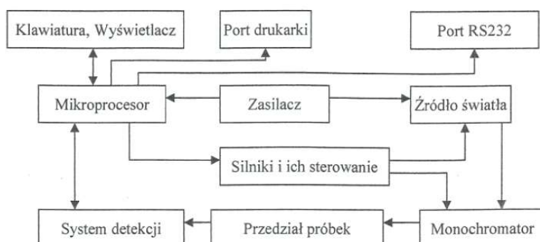
Rys. 3.14. Schemat blokowy spektrofotometru [23]
