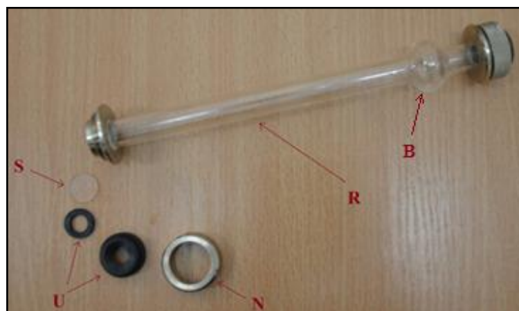
Rys.19. Rurka polarymetryczna R: S – szkiełko, U – uszczelki, N – nakrętka, B - uwypuklenie.
