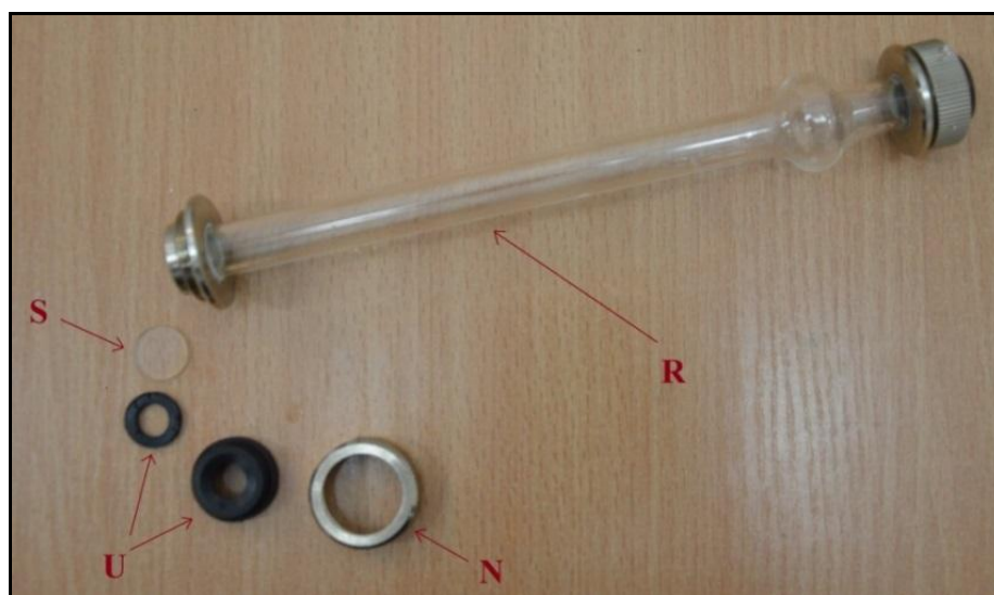
Rys.3. R - rurka polarymetryczna, S – szkiełko, U – uszczelki, N - nakrętka
