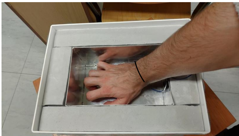
Rys. 2. Prawidłowa pozycja dłoni w kalorymetrze.
