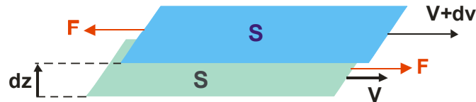
Rys. 2. Siły tarcia wewnętrzne podczas laminarnego przepływu cieczy.
