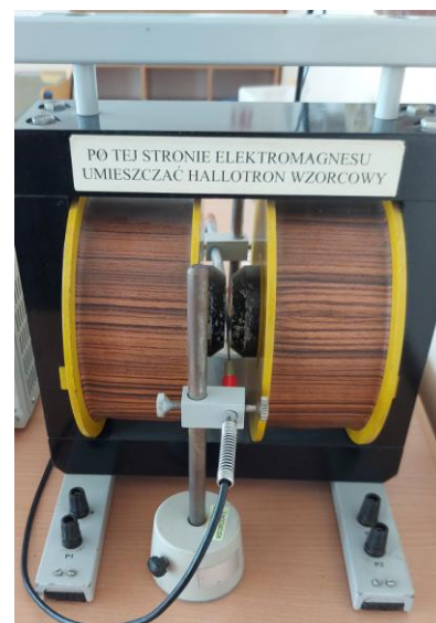
Rys. 5 Fotografia elektromagnesu. Na pierwszym planie widać sondę teslomierza, w głębi - hallotron badany
